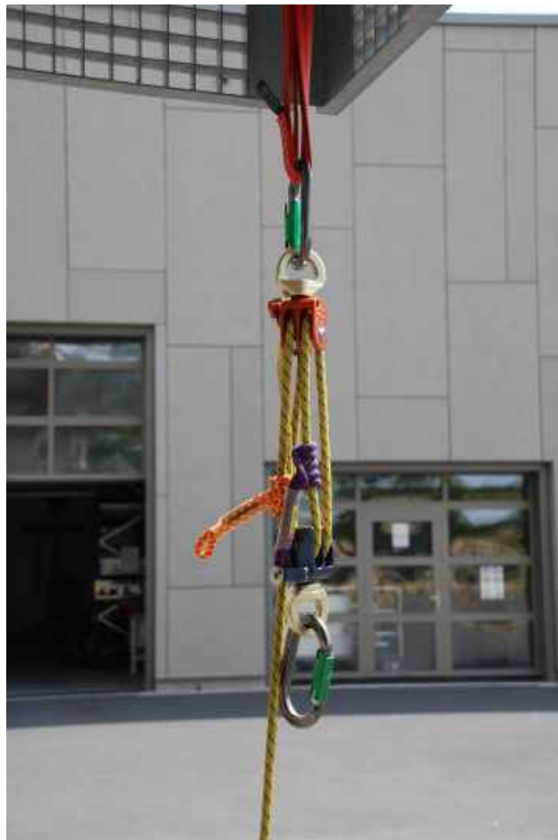
Aufbau eines Flaschenzuges, Absturzsicherungslehrgang
